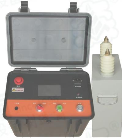
适用于 35kV 及以下电缆故障测试，是电力电缆故障测试中各类高阻性、接地型和疑难电缆故障定位的必备高压信号发生装置，广泛适用于各种电力电缆、路灯电缆、铁路信号电缆、通信电缆的粗测和精确定点，电缆故障测试种类包括各种高阻故障、闪络性故障、低阻接地故障等。
