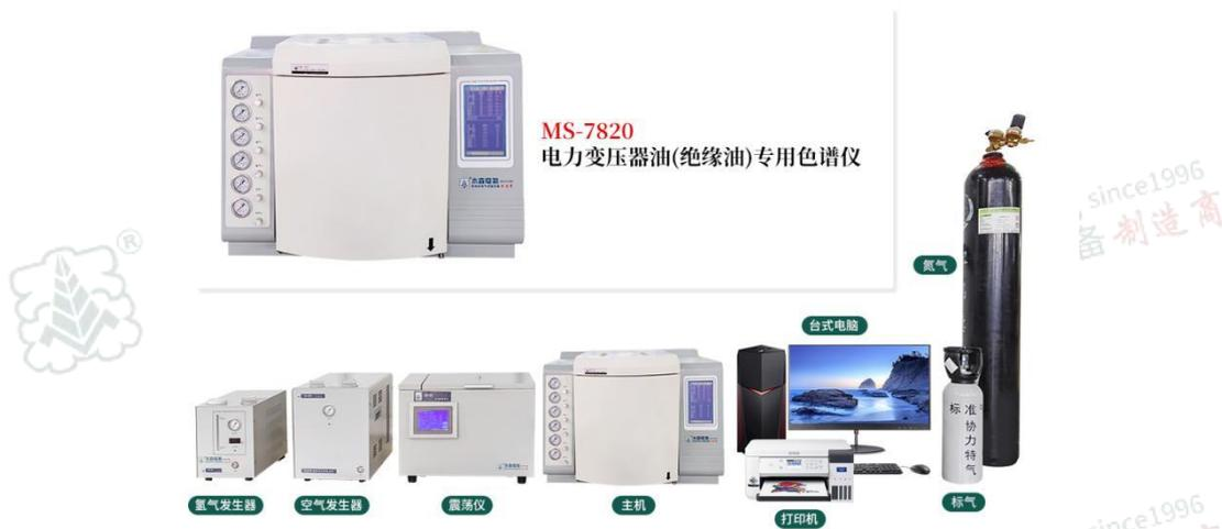
气相色谱法测定绝缘油中溶解气体的组分含量，是发、供电企业判断运行中的充油电力设备是否存在潜伏性的过热、放电等故障，以保障电网安全有效运行的有效手段，也是充油电气设备制造厂家对其设备进行出厂检验的必要手段。MS-7820 电力变压器油专用色谱仪采用国标推荐的三检测器流程，一次进样即可完成对绝缘油中溶解气体（包括  $H_2$ 、 $CH_4$ 、 $C_2H_4$ 、 $C_2H_6$ 、 $C_2H_2$ 、 $CO$ 、 $CO_2$ 、 $O_2$ 、 $N_2$ ）含量的全分析。
